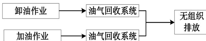
图3-2-1 废气处理流程示意图
